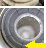
Gouging / Tearing
